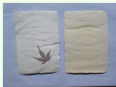
完成品 左が針葉樹に葉の漉き込み。右が広葉樹パルプにタマネギ染パルプを混合
